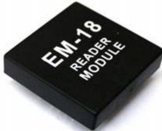
Fig 4: EM-18 RFID reader module
